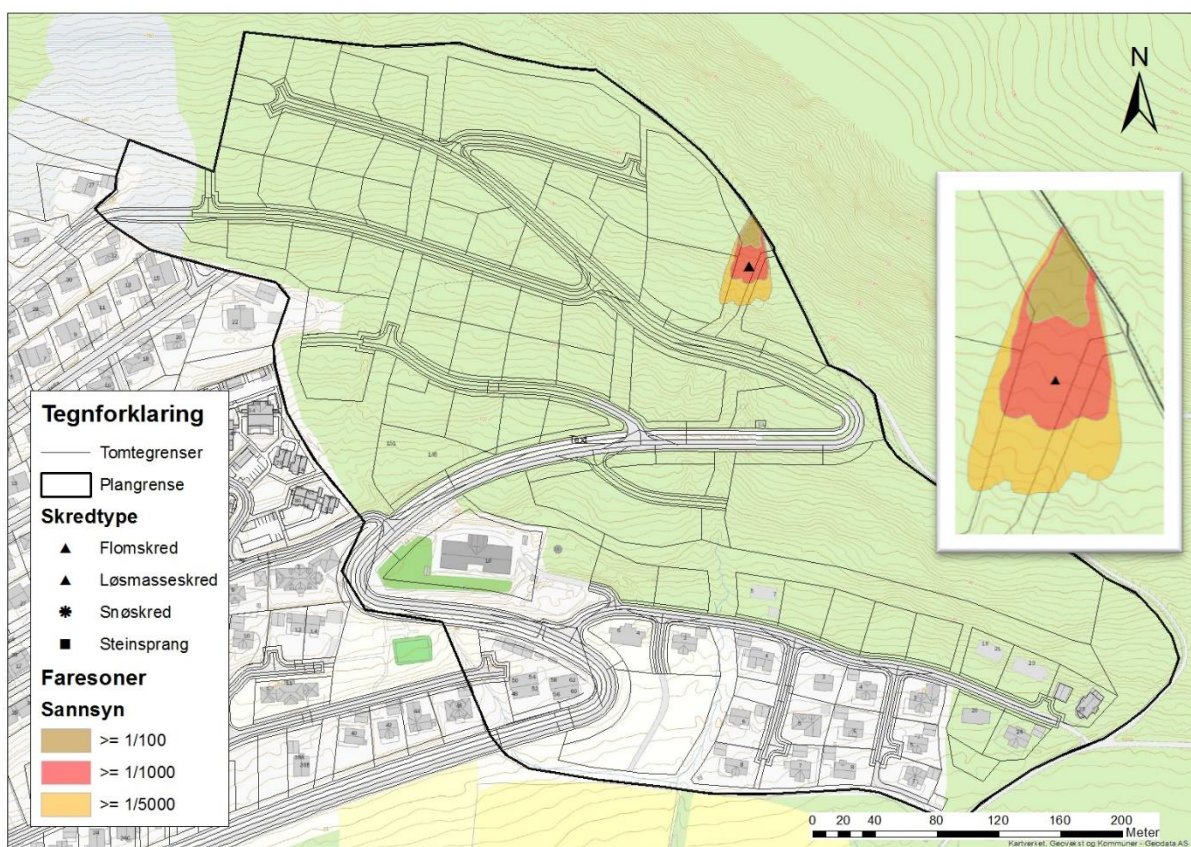
Figur 18: Faresoner for skred i planområdet. Det er tre faresoner med årlig sannsynlighet på henholdsvis 1/100, 1/1000 og 1/5000. Dimensjonerende skredtype er jord- og flomskred.
